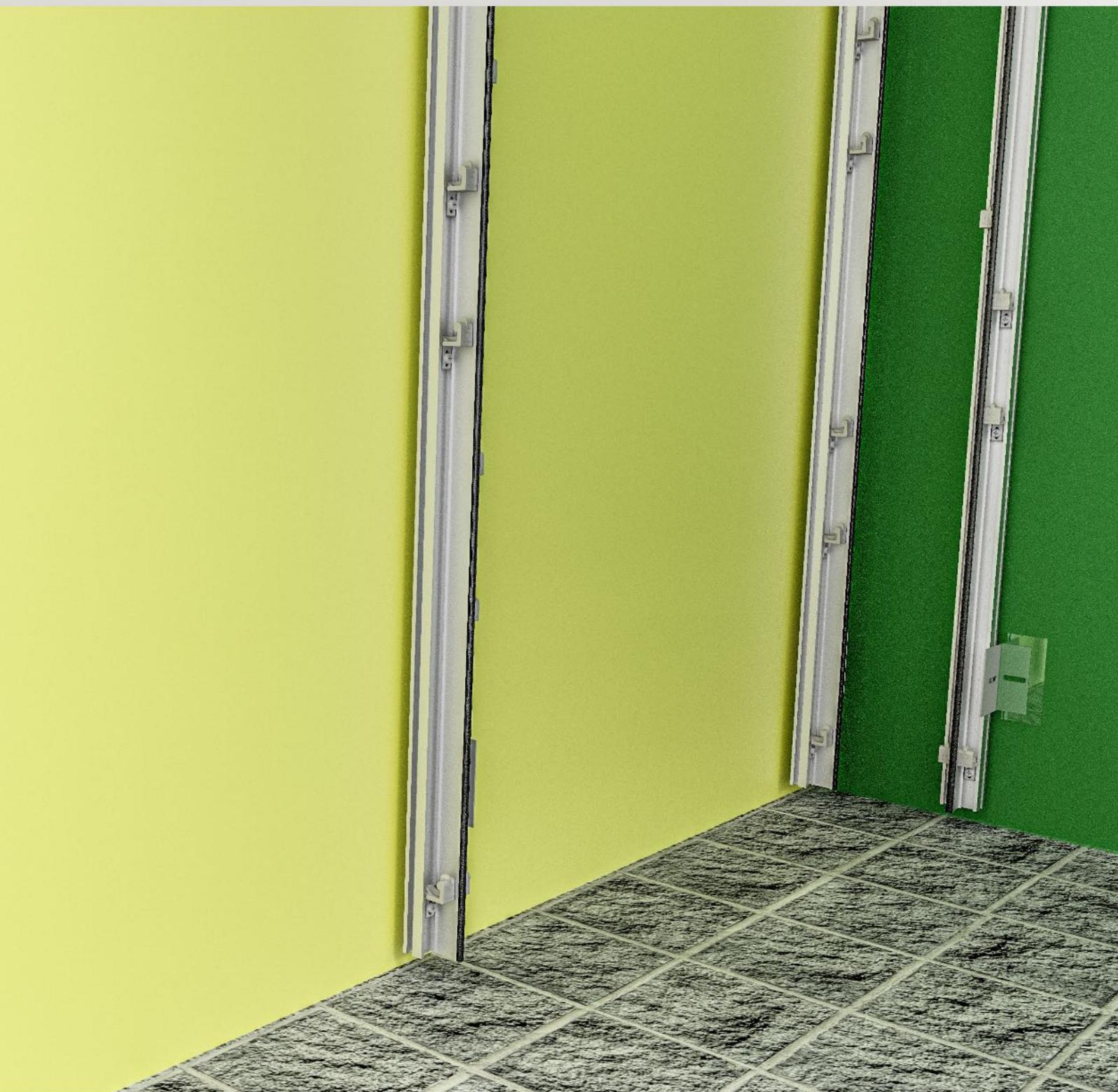
**Fig.04.i** | Anche in quest'altra vista si può notare l'applicazione sfalsata dei pioli PN-BT1 e/o PA-BT1.
