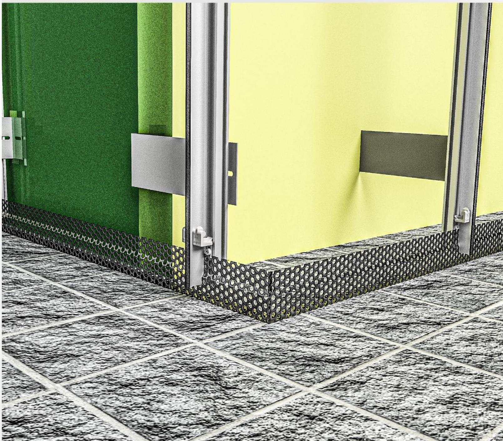
**Fig.05.a** | In questa vista si può notare il dettaglio dell'applicazione di lattonerie realizzate con lamiera forata (adeguata ad impedire formazione di ricettacoli e nidi di insetti), che costituiscono la griglia necessaria per la ventilazione della facciata.
