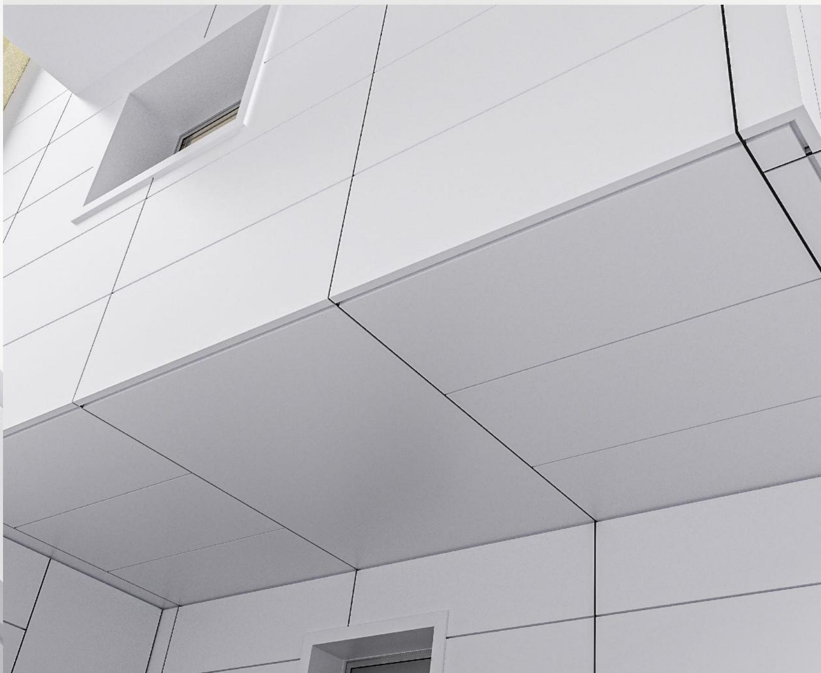
**Fig.09.c** | In questa vista si può notare il dettaglio dell'intradosso degli elementi aggettanti. Si consideri che questi elementi possono essere anche applicati come controsoffitti per rivestimenti di ambienti interni o rivestimento per coperture piane.
