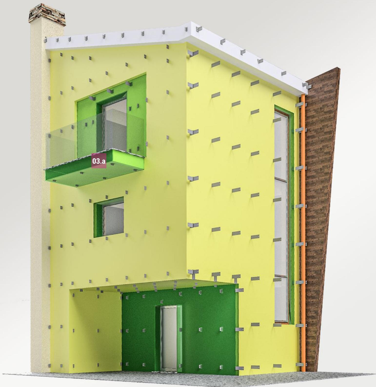
**Fig.03** | Applicazione, sull'involucro, dell'isolamento termico in base alle specifiche di fissaggio proprie del materiale impiegato. Il sistema non richiede la necessità di dover ripristinare l'omogeneità superficiale del supporto murario ma è necessaria, invece, l'omogeneità della funzione isolante del cappotto.
