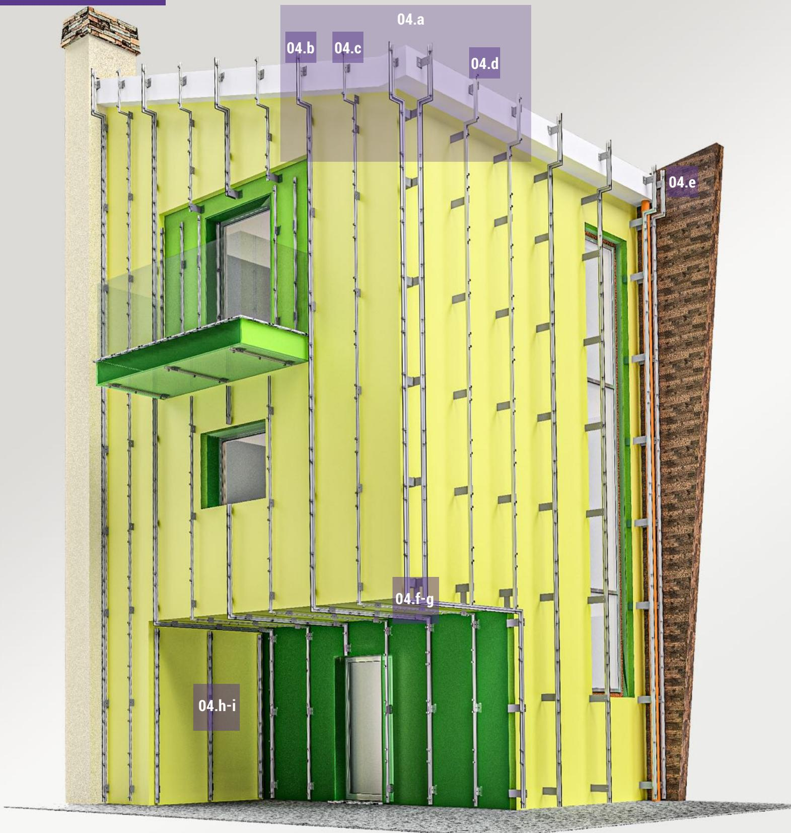
**Fig.04** | Si procede con l'installazione del sistema brevettato Bergami BT1 sul reticolo di staffe per mezzo del kit di bulloneria fornito, al fine di regolare i montanti tramite le cave di scorrimento sui profili d'alluminio. In particolare è opportuno rispettare gli aggetti ed i passi stabiliti, allineando il tutto con i piani derivanti dagli assi x-y-z, al fine di ottenere un risultato a regola d'arte.
