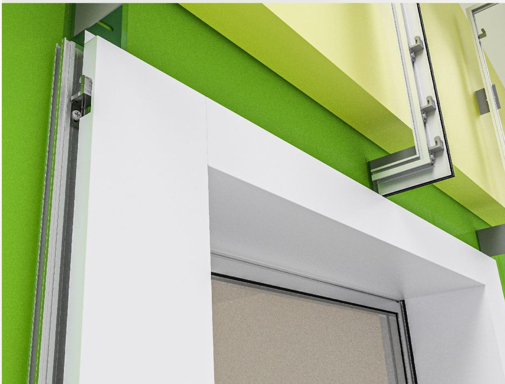
**Fig.06.a** | In questa vista si può notare il dettaglio dell'imbotte LINEAR DELUXE. I pannelli d'imbotte si integrano linearmente al contesto stilistico della facciata. Questa tipologia di imbotte è ottenuta con l'utilizzo del montante MC-BT1 posato con fuga accostata minimal (ovvero fuga architettonica quasi zero), ma può esser realizzata anche adoperando altri montanti del sistema BT1.
