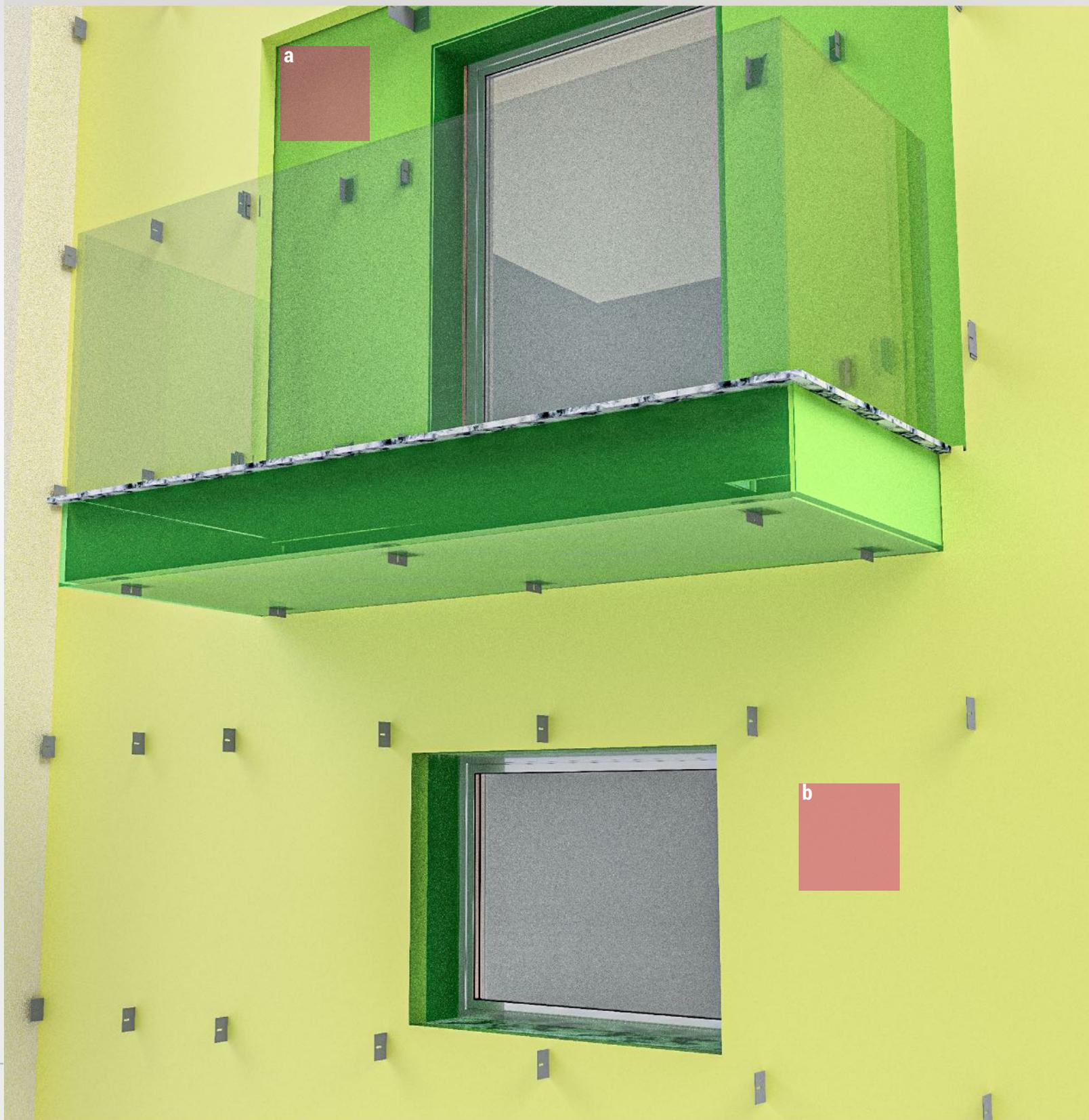
**Fig.03.a** | Nell'esempio presentato sono stati adoperati cappotti di spessore diverso, simulando casistiche quanto più possibili reali. Un primo tipo di cappotto termico è quello da 20 mm (a) ad alta densità, applicato in aree dell'involucro con aggetti contenuti (balconi, androni, imbotti infissi, etc.). Nelle aree dell'involucro ove non si rinvengono problematiche di spessori minimi sugli aggetti è stato ipotizzato, invece, un isolante da 120 mm (b).
