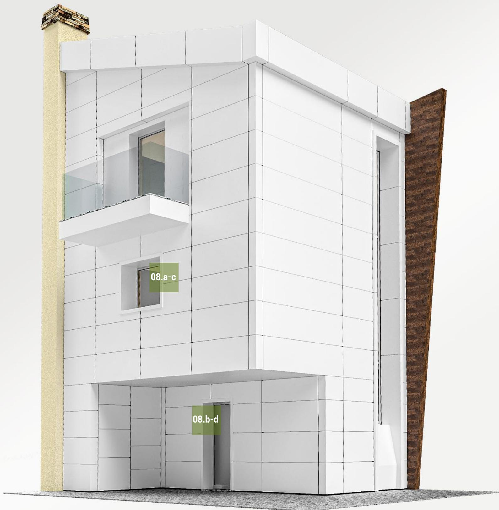
**Fig.08** | La soluzione denominata BASIC ovvia eventuali problemi di suddivisione dei pannelli e la coincidenza con le fughe degli stessi, che impedisce l'applicazione degli imbotti DELUXE; questa tipologia di imbotti rende la lavorazione e la posa più standardizzabile in situazioni di finestrate non perfettamente allineate orizzontalmente e verticalmente tra loro. Tali imbotti vengono montati come finitura terminale dell'opera di rivestimento.
