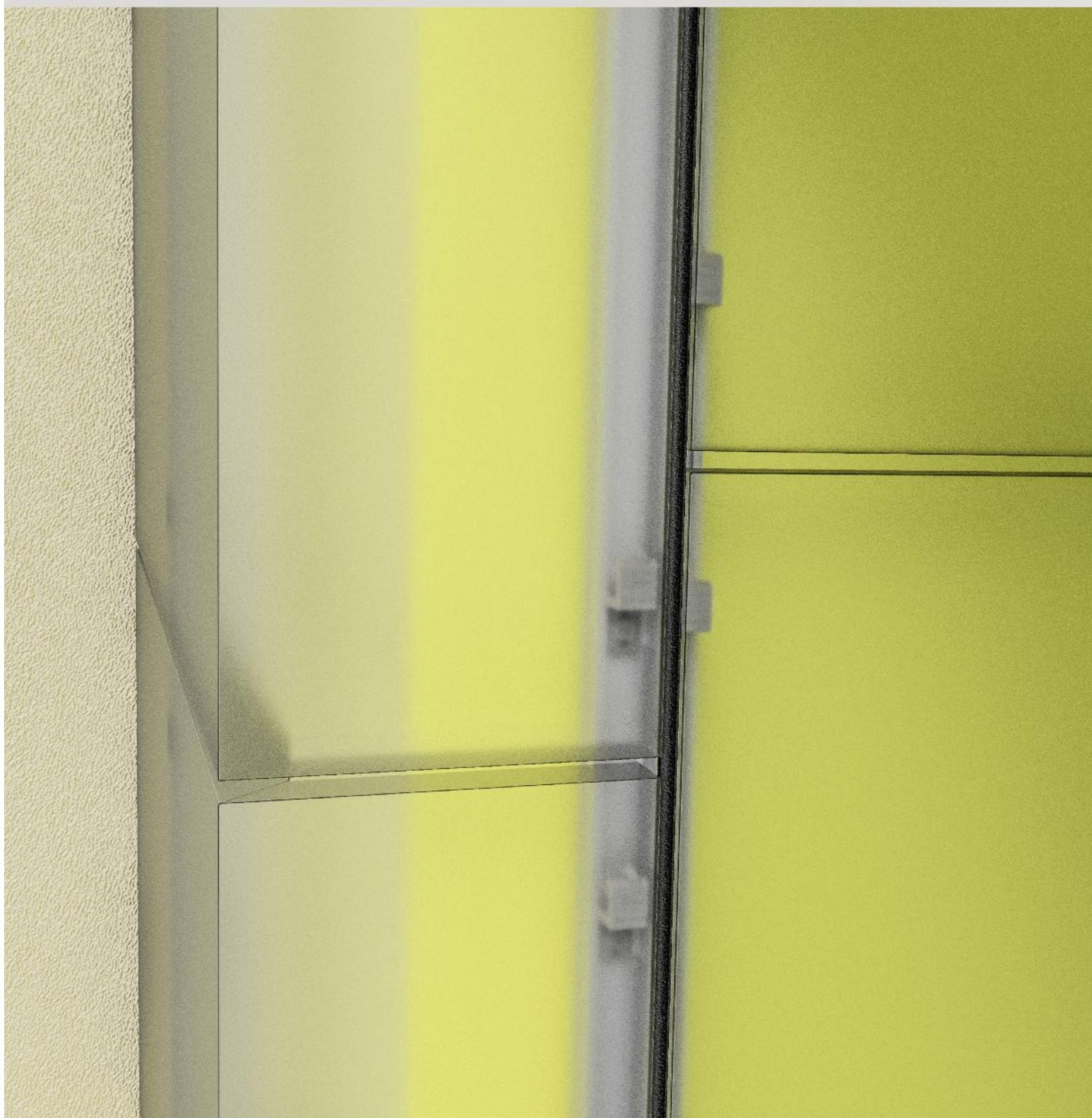
**Fig.04.h** | In questa vista si può notare il dettaglio relativo alla possibilità di realizzare in modo facile suddivisioni che prevedano pannellature sfalsate orizzontalmente, grazie al sistema dei pioli sdoppiato dx/sx; questo, inoltre, preserva dal dover replicare le lavorazioni degli agganci sfalsati sulle pannellature, standardizzando le stesse lavorazioni di tranciatura e mantenendo l'integrità e la rigidità delle pieghe di rinforzo laterale dei pannelli.
