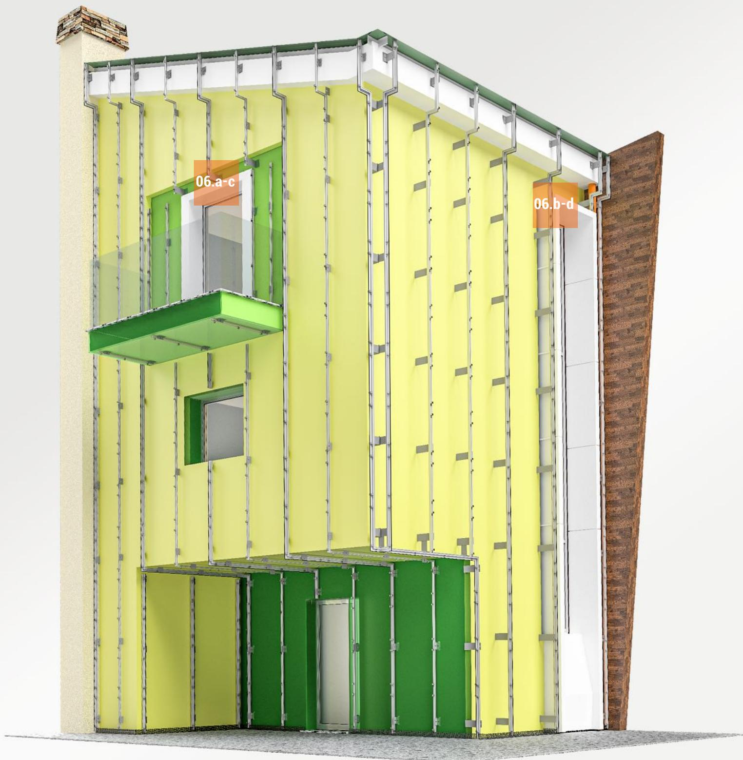
**Fig.06 |** Si procede con l'installazione degli imbotti ed i pannelli speciali (angoli, terminali, etc.) in modo da poterli fissare sull'anima centrale porta gomma della sottostruttura BT1 (qualora ve ne fosse la necessità). Gli imbotti DELUXE sono parte integrante della pannellatura e si fondono in modo armonico nel contesto, offrendo le finiture di un'estetica lussuosa in assenza di fissaggi a vista.
