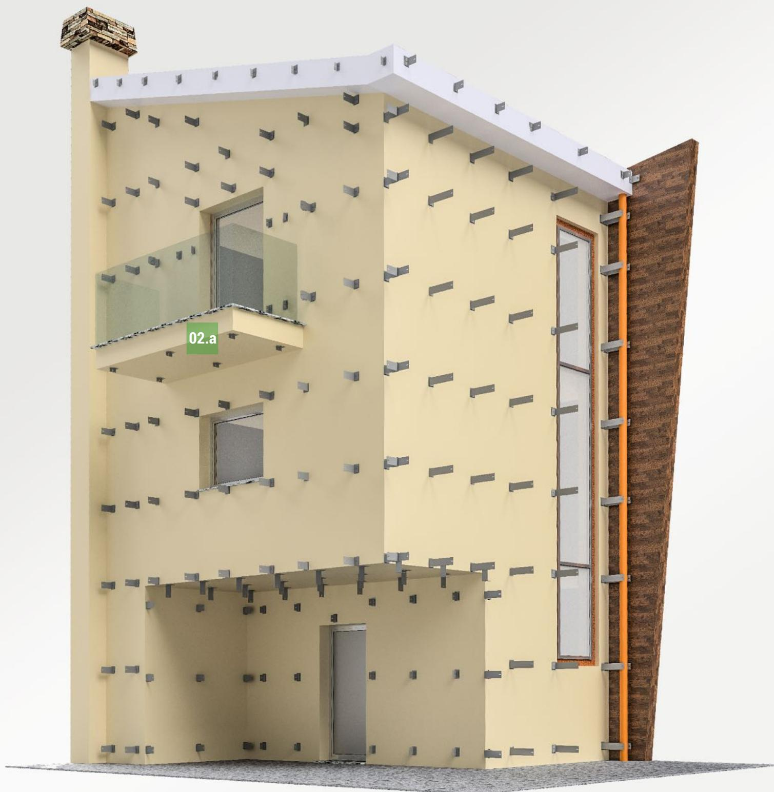
**Fig.02** | Applicazione del reticolo di staffe sull'involucro esterno, in base agli allineamenti dei passi verticali dei montanti ed alla distribuzione verticale prevista in fase di progettazione.
